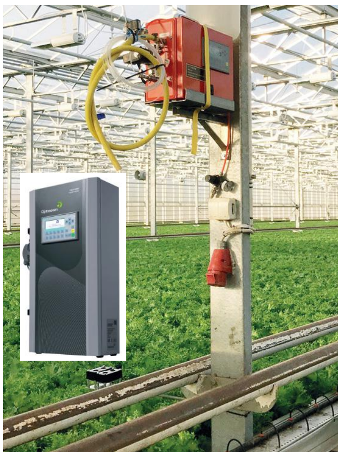
Jatkuvatoimisella mittausteknologialla voidaan valotus mitata suoraan kasvuston tasolta ja nitraatti kastelulannoiteliuoksesta. Kuvassa on myös tutkimuksenaikainen prototyyppi nitraattianalysaattorista, joka on nykyisellään pikkukuvan kaltainen laite.
